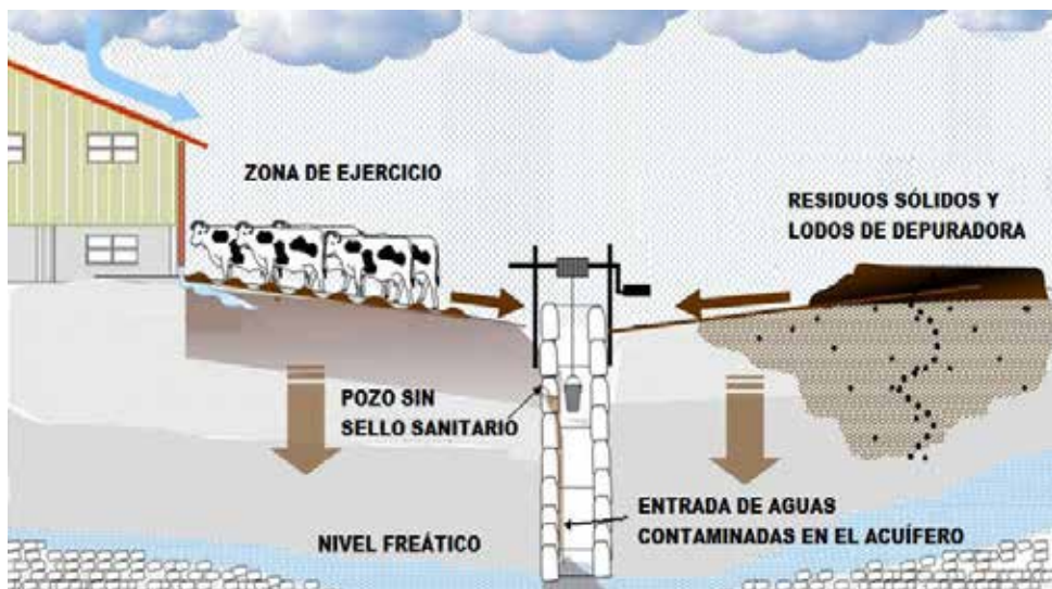
Figura 8. Contaminación de acuífero por falta de sello sanitario
