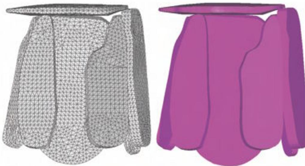
Figura A1.7. Malla de elementos finitos (izda.) y visualización con sombreado (dcha.), vista frontal
