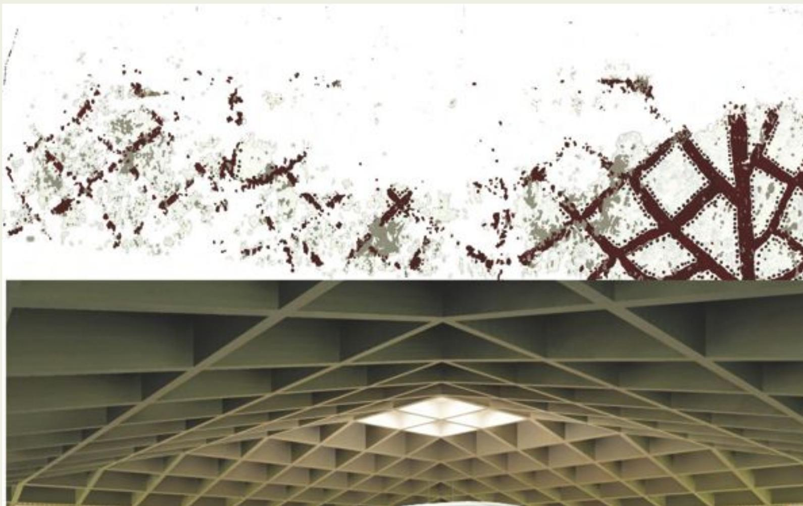
Una malla cuadrangular plana de madera laminada se deforma y convierte en cubierta a cuatro aguas. La deformación facilita el comportamiento de la estructura. La diagonal se vacía.
