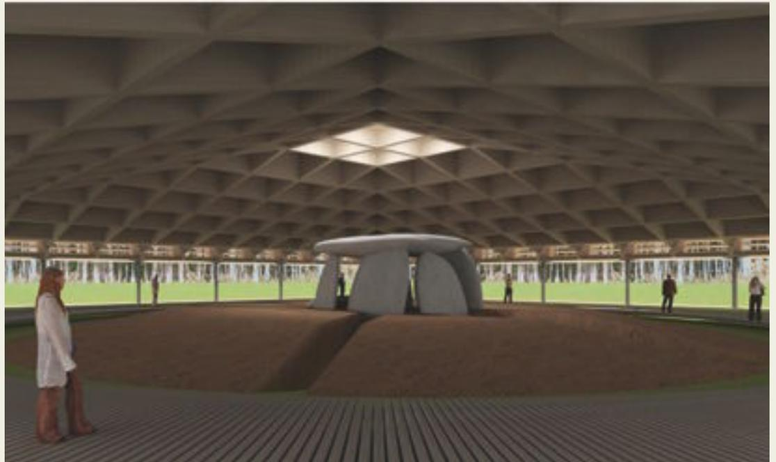
La caja de madera de la cubierta se hace opaca y oscura, de esta forma se consigue que levite sobre la franja de luz del zócalo. La configuración a cuatro aguas focaliza el espacio que aparece significado por la linterna central, que a través de sus lamas de vidrio y los cuatro amplificadores de luz natural, iluminan suavemente la arquitectura del túmulo.
