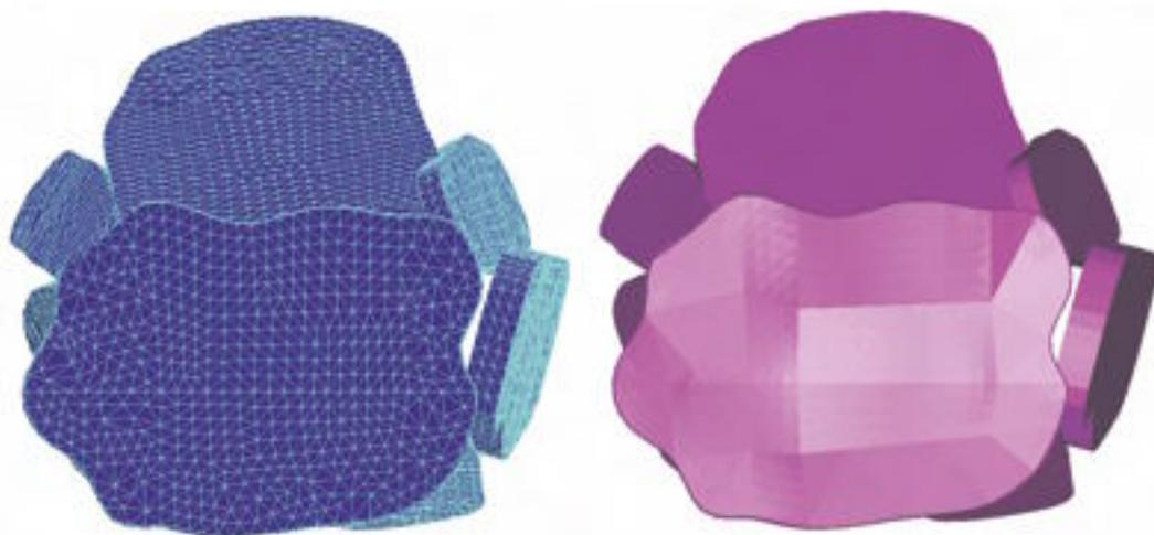
Figura A1.8. Malla de elementos finitos (izda.) y visualización con sombreado (dcha.), vista en planta superior
