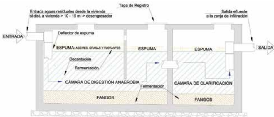
Figura 6. Perfil transversal dunha fosa séptica e esquema de funcionamento – Elaboración propia
